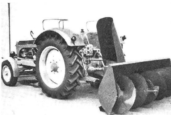
Die Schneekenschneeschleuder Typ SS/220/70 für Frontmontage ist bestimmt für Traktoren ab 50 PS. Räumbreite 220 cm, Räumhöhe je nach Schneebeschaaffenheit bis 100 cm, Räumleistung je nach Schneebeschaaffenheit 1300–7000 m<sup>3</sup>/h, Räumgeschwindigkeit je nach Schneebeschaaffenheit 0,6–3 km/h.; Superkriechgang erforderlich, Antrieb von hinterer Zapfwelle mittels Gelenkwellenstrang nach vorne, Anheben mit hydraulischem Hubzylinder, Auswurf-
