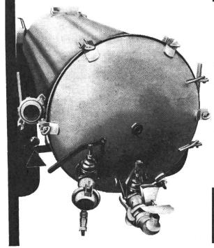
Wenn Sie einen zweiten Anschlussstutzen wählen, brauchen Sie den Feldverteiler zum Fassfüllen nicht wegzunehmen. Das Saugrohr kann sofort angeschlossen werden. Das ist praktisch und bedeutet Arbeitsund Zeitersparnis.
