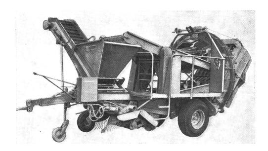
Ausnahme von Kleinvollerntern wurde der Bunkerinhalt bei allen anderen Ausführungen auf 1000 bis 1800 kg Kartoffeln vergrössert. Bei den Vollerntern «Wisent» wurden ebenfalls viele Neuerungen festgestellt, die sowohl zur Erhöhung der Arbeitsqualität als auch der Arbeitsleistung führen sollen. Ein neuer, zweireihiger Grossvollernter ist für die normale und die zweistufige Erntemethode verwendbar. Nach Wegnahme des Hubrades
