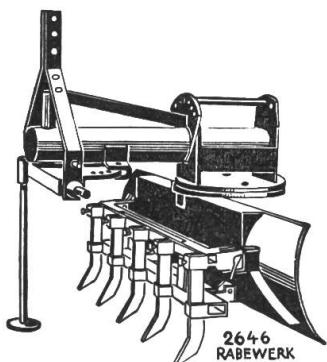
Planiergerät für den Strassenunterhalt und Planierarbeiten 183 oder 213 cm ab Fr. 1490.— auf Wunsch mit Stützrad.
