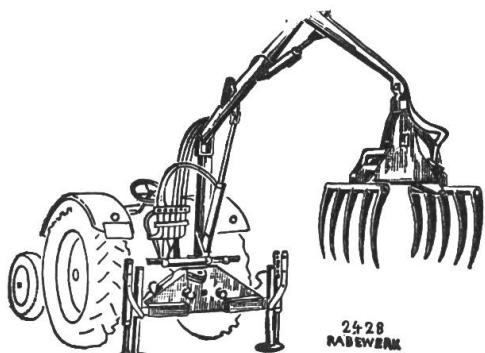
Hydraulischer Hecklader mit mechanischer oder hydraulischer Abstützung. Diverse Greiferwerkzeuge oder mit Tiefloßel. Greifer Füllgewicht ca. 450 kg komplett mit Dunggreifer ab Fr. 3950.—
