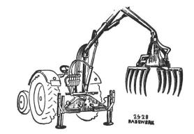
Hydraulischer Hecklader mit mechanischer oder hydraulischer Abstützung. Diverse Greiferwerkzeuge oder mit Tieflöffel. Greifer Füllgewicht ca. 450 kg komplett mit Dunggreifer ab Fr. 3950.—.
