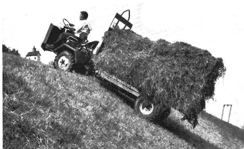
Abb. 4: Der Transporter im Seilaufzugverfahren bei 85 % Steigung.
