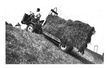
Abb. 4: Der Transporter im Seilaufzugverfahren bei 85 % Steigung.
