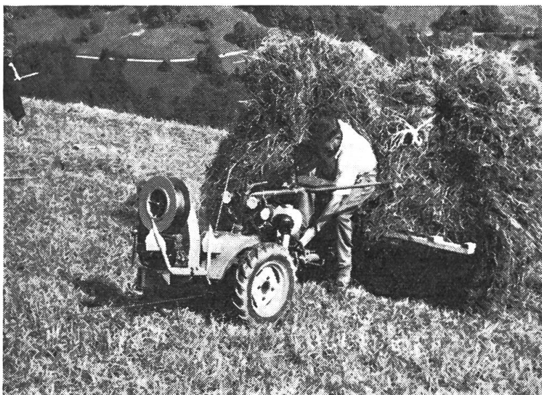
Abb. 3: Selbstaufzugverfahren kombiniert mit leichtem Bergmäher.
