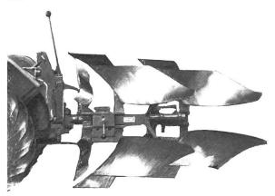
Die Pflugkörper weisen gewundene Riestern und Messerseche auf, die gleichzeitig als Träger der zweiteiligen Vorschäler dienen. Eine Bruchsicherung mit einstellbarem Federbolzen ist im Anbaurahmen eingebaut. Nach Auslösen derselben schwenkt der ganze Pflug nach oben.
