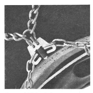
Die neue Art Schneeketten anzupassen: Durch Verschieben der äussersten Kettenglieder aus der Grundstellung des Verstellelementes in die längeren Rillen können pro Element 2 cm gewonnen werden.
