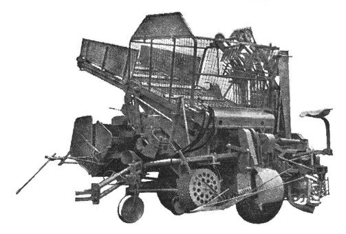
schneidet die Blätter, rodet, putzt und erntet eine Reihe in einem Arbeitsgang. Vollhydraulisch. Rübenbunker. Einwandfreie und rascheste Ernte, auch bei schwierigen Bodenverhältnissen. Ein-Mann-Bedienung.
