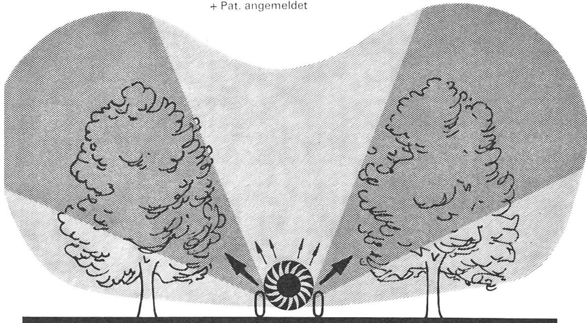
Die neue Doppelausblasung der Luft in den Baumkronen-Oberteil hat sich in der Praxis bestens bewährt. Die üblicherweise am Austritt gegen den Boden verhinderte, aufgestaute Luftmenge von ca. 25 % wird nunmehr durch ein durchdachtes, neuartiges Leitsystem in die Zone verstärkten Luftbedarfes geleitet: Damit wird die Wirksamkeit durch höheren Leistungsgrad wesentlich verbessert.
