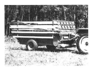
Durch die Auslegung als Tieflader weist der Hamster minor eine grosse Ladefläche (12 m³ Heu, bzw. 6 m³ Grünfutter) und eine günstige Schwerpunktlage auf, ohne aber dabei eine störende Ueberbreite zu erhalten (Spurweite nur 1,80 m). Mit dem vollbeladenen Wagen kann so jedes Gelände befahren werden, das sich noch irgendwie für den Traktoreinsatz eignet.
