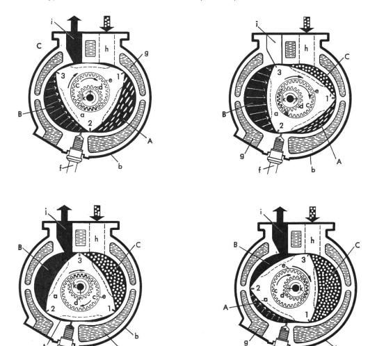
Abbildung 2: Schematische Darstellung der Arbeitsweise eines Kreiskolbenmotors. 1 bis 3 Dichtleisten des 3eckigen Kolbens zum Abteilen der drei Arbeitskammern A bis C
