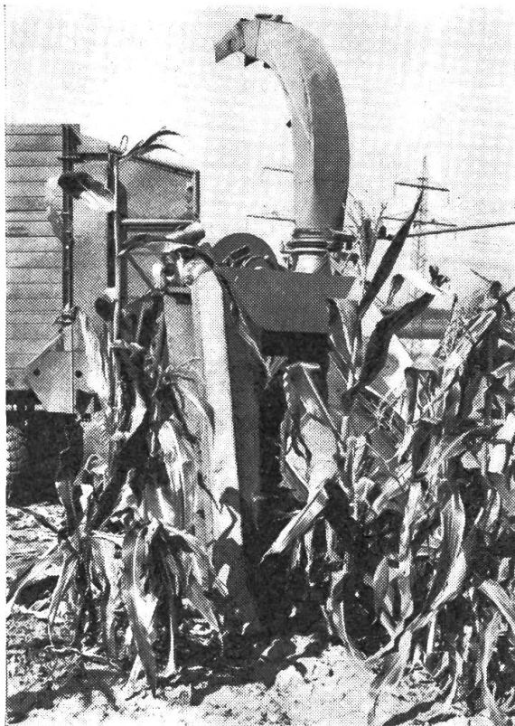
Scheibenradfeldhäcksler bei der einreihigen Maisaufnahme. Im Hintergrund deutlich ein zusätzlich angebautes Messerschleifgerät mit 2-Takt-Ottomotor sichtbar.
