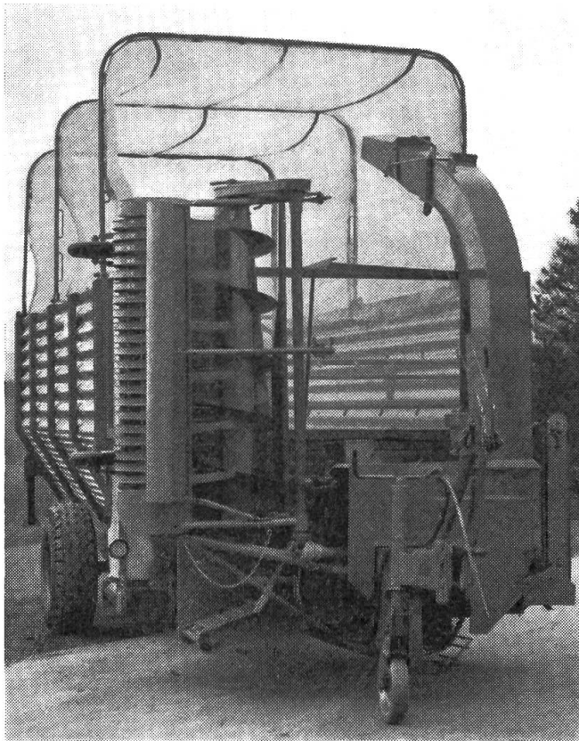
Häckselladewagen mit hydraulisch hochgeschwenkter Pick-up-Trommel für die Strassenfahrt.
