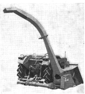
Heckansicht eines Anbau-Trommelhäckslers, die Anhängekupplung des Schleppers bleibt frei.
