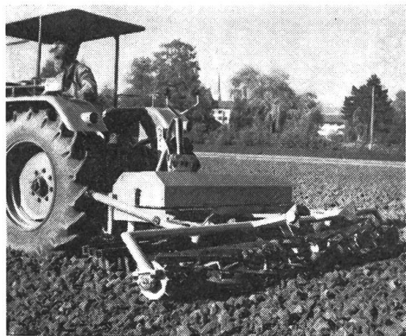
Abb. 27 und 28: Die Rütteleger werden meistens mit zwei oder drei Zinkenbalken ausgerüstet. Zum Ausebnen der seitlichen Erdschollen-Schwaden dienen Schleppbalken oder Drahtwalzen.
