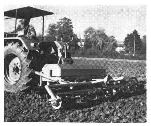
Abb. 27 und 28: Die Rütteleggen werden meistens mit zwei oder drei Zinkenbalken ausgerüstet. Zum Ausebnen der seitlichen Erdschollen-Schwaden dienen Schleppbalken oder Drahtwalzen.
