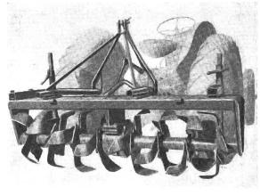
Abb. 24 und 25: Die Zapfwellen-Spatenegge mit leicht abgewinkelten Spaten eignet sich zum Struchen und Saatbettherstellen (Abb. 24). Eggen mit Winkelspaten arbeiten weniger tief, jedoch intensiver und werden vor allem zum Struchen und Einfräsen von Gründung bevorzugt (Abb. 25).
