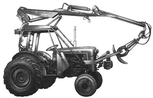
Greiflader, Dachaufbau, in Transportstellung
