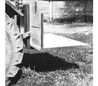
Abb. 2: Ansicht von der Seite. Man erkennt die beiden u-förmigen Träger und den Anbau an das 3-Punkt-Gestänge.
