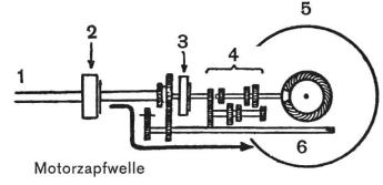
Die Wegzapfwelle, früher auch wegabhängige, fahrabhängige oder gangabhängige Zapfwelle, ändert ihre Drehzahl mit dem eingeschalteten Getriebegang. Ihr Antrieb wird nach dem Wechselgetriebe abgezweigt. Das Uebersetzungsverhältnis von den Triebrädern zur Wegzapfwelle ist konstant; daher bleibt die Zahl der Umdrehungen der Wegzapfwelle je Meter Wegstrecke gleich, ungeachtet der Drehzahl des Motors und des jeweils eingeschalteten Getriebeganges. Besondere Bedeutung hat die Wegzapf-
