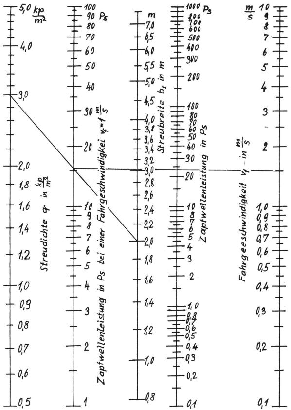
Gilt für schweren, strohigen Dünger mit dem Frontlader aufgeladen für Handbeladung kann q' = 0,75 q und für sehr gut streufähigen Dünger kann q' = 0,5 q gesetzt werden.
