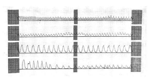
Abb. 1: Verlauf der Zapfwellenleistung bei verschiedenen Ladewagetypen. 1 mm Ausschlag = 1 PS.
