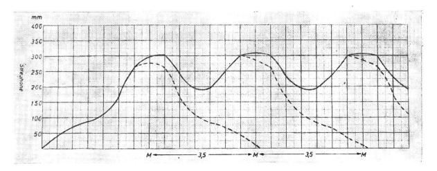
Abb. 4: Düngerverteilung quer zur Fahrrichtung nach einem Stallmiststreuer.
