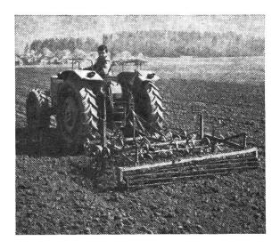
Abb. 20, 21 und 22: Zum Ergänzen der Vibrierzinken-Kultivatoren haben sich Krümler mit 2 nacheinander angebrachten Drahtwalzen bewährt (Abb. 20 und 21). Ausführungen mit nur einer Walze arbeiten nicht so intensiv und passen sich den Bodenunebenheiten weniger gut an (Abb. 22).
