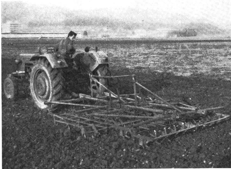
Abb. 18: Eine Gerätekombination, bestehend aus einer Löfflegge und einem Krümmer (Drahtwalze), eignet sich sehr gut für die Saatbettvorbereitung für Zuckerrüben.
