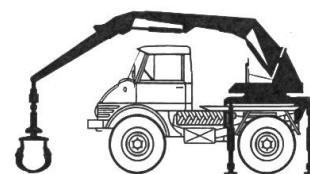
Unimog mit Greiferkran. Ausladung bis 5 m.
