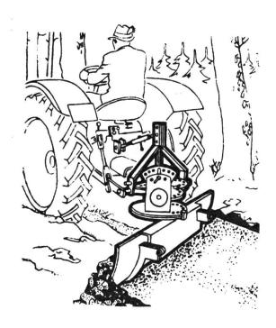
Die Einsatzmöglichkeiten sind besonders durch die verschiedenen Verstellungen sehr vielseitig. Das Gerät kann horizontal und vertikal jeweils nach beiden Seiten verstellt werden. Für die Rückwärtsfahrt ist eine Schwenkung um 180° möglich. Der Tiefgang wird durch höhenverstellbare Schleifschuhe begrenzt.
