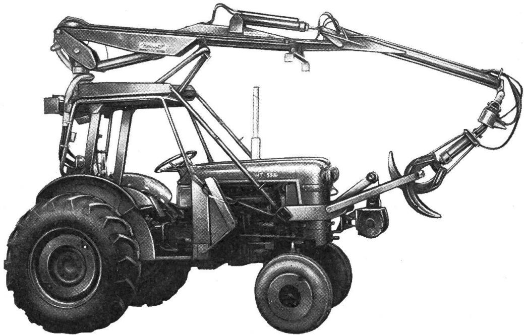
Greiflader, Dachaufbau, in Transportstellung
