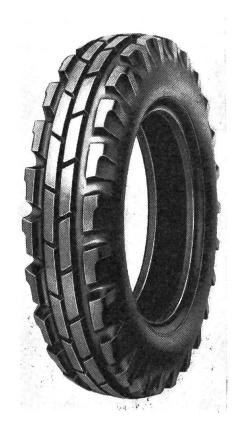
Aeltere Frontreifen zeigen lediglich ein reines Spurprofil in Gestalt umlaufender Rippen. Bei dem modernen Frontprofil sind die Mittelrippen noch in Einzelblöcke aufgeteilt, so dass die Bedingungen einer guten Spurhaltung auf dem Acker mit verbesserter Selbstreinigung und Steigfähigkeit aus den Ackerfurchen mit den Forderungen guter Fahreigenschaften auf fester Strasse weitgehend in Einklang gebracht werden.
