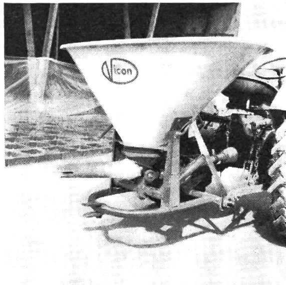
Abb. 9: Der Pendel-Düngerstreuer kann ohne Spezialrührwerk für angefeuchtetes Thomasmehl eingesetzt werden. Die Streugenauigkeit ist gut. Für das Ausbringen von Thomasmehl mit Kalisalz eignet er sich hingegen weniger, da die Mischwirkung des Rührwerkes ungenügend ist.
