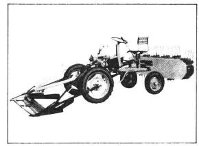
Mit dem Schnellheuer als Zusatzgerät können Sie ermüdungsfrei sitzend gleichzeitig mähen und zetten oder Schwaden ziehen sowie auch wenden oder rechen.
