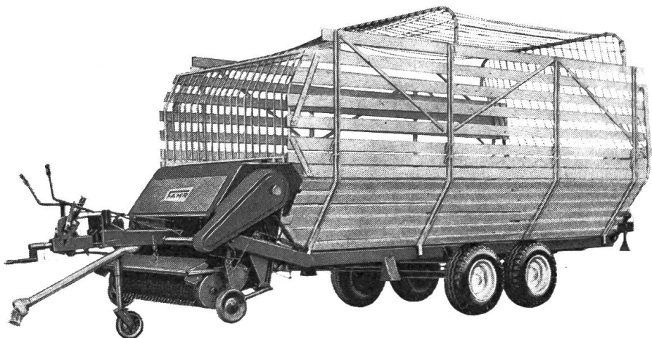
Ladewagen FAHR WE 331 mit Tandemachse
