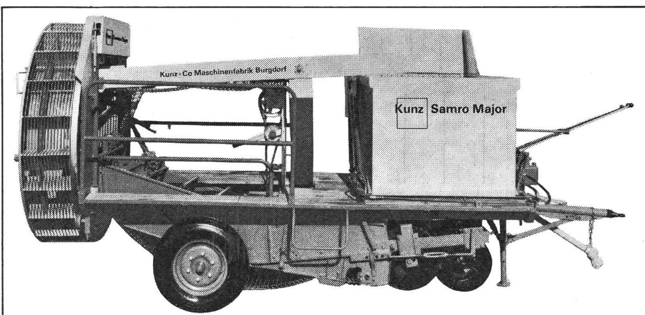
Der Samro-Major ist mit Absackstand, Überladeelevator oder hydraulisch bedienbarem Kippbunker von über 1100 kg Fassungsvermögen lieferbar. Die einzelnen Ausrüstungen können gegeneinander ausgetauscht werden.
