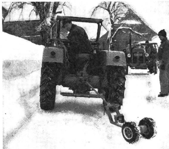
Exaktes Messgerät zur Ermittlung der Höchstgeschwindigkeit.
