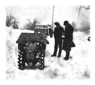
Geschwindigkeits-Messung und Bremsprobe erfordern bei derartigen Witterungs-Bedingungen einiges Finger- und Zehenspitzengefühl.
