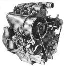
Die neuen, luftgekühlten Deutz-Dieselmotoren haben einen grösseren Zylinderinhalt und arbeiten mit Direkteinspritzung.
