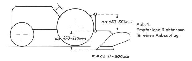
Der Umstand, dass ein Pflug für Regelhydraulik bei der Arbeit durch den Traktor getragen und in der Arbeitstiefe reguliert wird, hat zur Folge, dass die Pflugsohle und die Stützrolle überflüssig sind. Die unerwünschten Reibungs- und Rollwiderstände und dadurch auch der Zugwiderstand werden erheblich reduziert.
