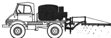
Unimog mit Feldspritze. Arbeitsbreite bis 20 m. 1000-l-Tank auf der Pritsche.
