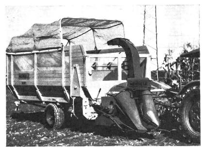
Trommel-Feldhäcksler, angebaut auf einen Automatikwagen, wobei wahlweise ein Pick-up- oder Mais-Schneidwerk rechts neben dem Traktor arbeitet. Die Aufnahmevorrichtungen werden für den Strassentransport hydraulisch angehoben. Der Automatikwagen liegt im direkten Zug hinter dem Traktor. Ein Zapfwellen-Durchtrieb für das Abladegebläse ist vorgesehen, so dass auf einen Motor für das Gebläse verzichtet werden kann.
