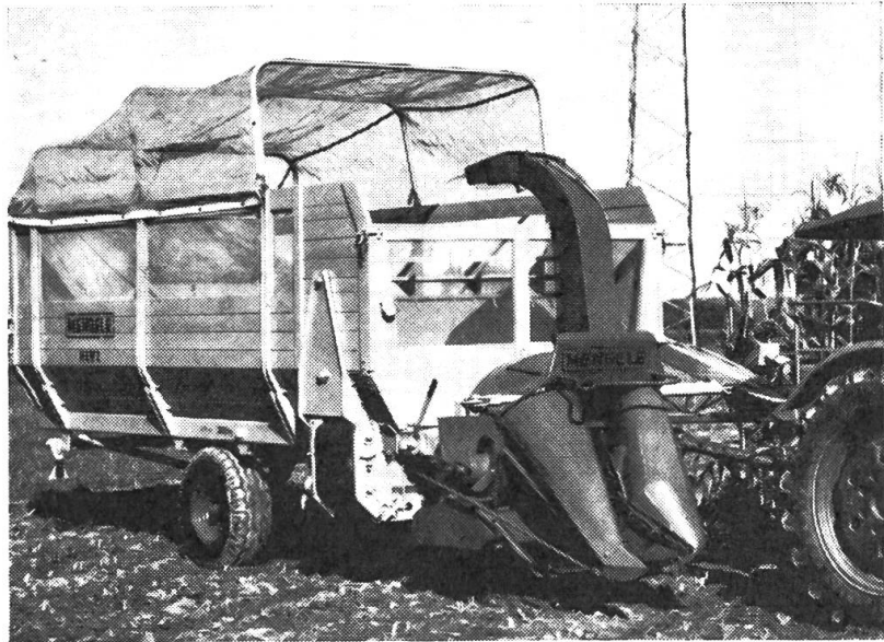
Abb. 3: Häcksel-Ladewagen mit Maisgebiss, Dosierwalzen und umschaltbarem Querförderband für links- und rechtsseitigen Auswurf
