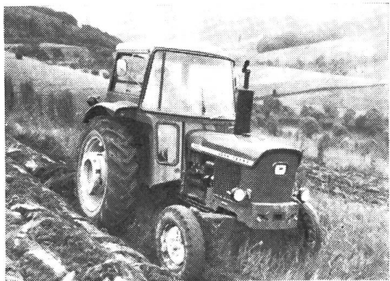
Abb. 2: John Deere 920 (40 PS) – Nr. 2 der neuen Reihe 8 Vorwärts- und 4 Rückwärtsgänge – kupplungsunabhängige automatische Kombinations-Regelhydraulik mit Mischregelung und Regelung über die unteren Lenker! Wassergekühlter Dreizylinder-Viertakt- Dieselmotor mit Direkteinspritzung – Muffenschaltgetriebe.
