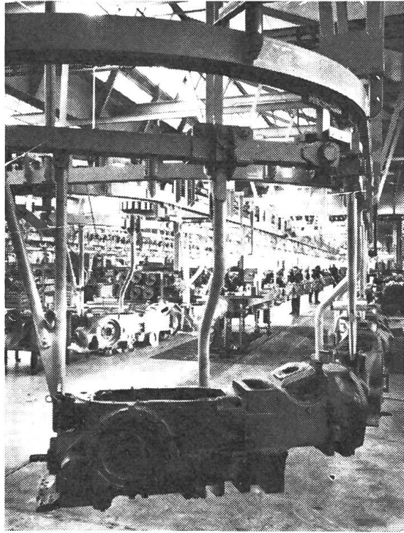
Abb. 5: John Deere Werke Mannheim — Getriebemontage Eines der wichtigsten Elemente des moder- nen Traktors wird hier präzise und rationell montiert.
