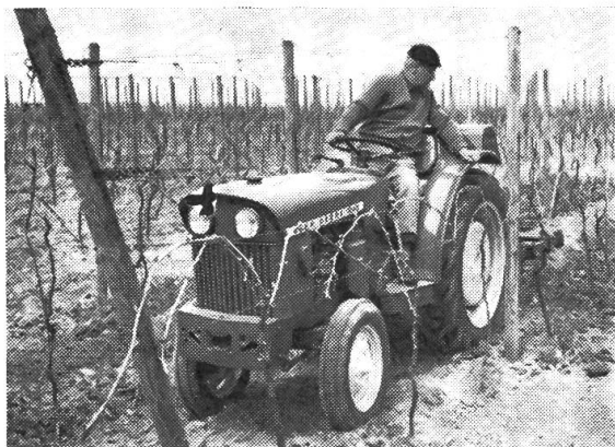
Abb. 1: John Deere Weinbau-Traktor 1020 (47 PS) Nr. 4 der neuen Reihe Für die besonderen Einsatzbedingungen im Wein- und Hopfenbau, im Obst- und Gemüsebau wurde dieser Traktor von nur 98 cm Breite entwickelt. Er hat alle technischen Eigenschaften des «1020», ist zuverlässig, wirtschaftlich, sicher und bequem.
