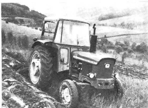
Abb. 2: John Deere 920 (40 PS) — Nr. 2 der neuen Reihe 8 Vorwärts- und 4 Rückwärtsgänge — kupplungsunabhängige automatische Kombinations-Regelhydraulik mit Mischregelung und Regelung über die unteren Lenker! Wassergekühlter Dreizylinder-Viertakt- Dieselmotor mit Direkteinspritzung — Muffenschaltgetriebe.
