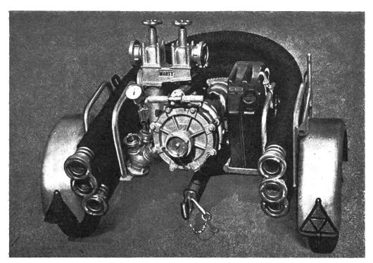
Abb. 1: Ansicht der Zapfwellenpumpe.
