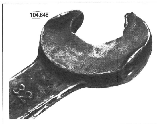
Abb. 3: Falsch! Schadhafte Schlüssel sollen weggeworfen werden.
