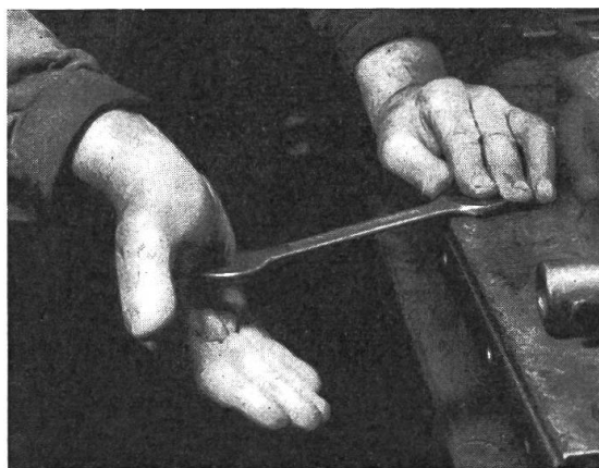
Abb. 8: Richtig! Muss der Schlüsselgriff gestossen werden, dann soll dies mit offener Handfläche geschehen, damit Knöchelverletzungen vermieden werden.
