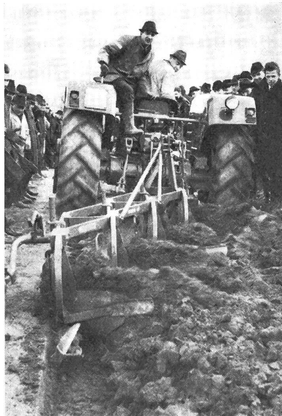
Abb. 2: Der lange und schwere Pflug erfordert trotz Regelhydraulik eine Stützrolle am Heck. ►
