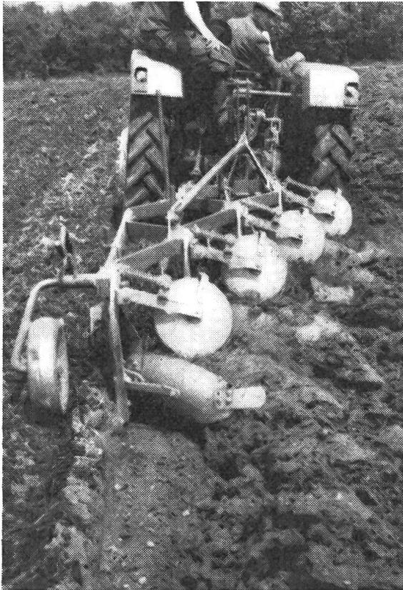
◀ Abb. 5: Dieser Pflug ist mit besonderen (gefederten) Düngereinlegern und gezackten Scheibensechen ausgestattet.
