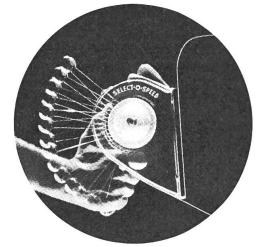
beim Schalten. Mit der Hand den Schalthebel fassen und in den nächsten Gang schieben. Das ist alles. Das Getriebe ist immer im Eingriff, sogar im Moment des Schaltens. Einen Freilauf gibt es nicht. Das Select-O-Speed-Getriebe wirkt gleichzeitig als Motorbremse. Eine Handbremse ist also überflüssig. Ideal im coupierten Gelände der Schweiz.
