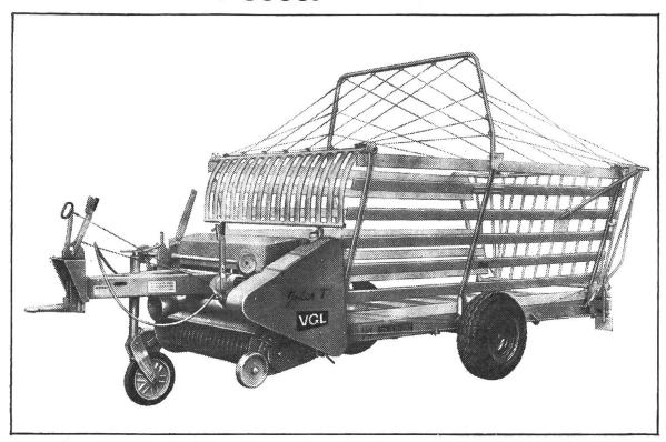
"Joker T" ein neuer Tieflader von Lely-Dechentreiter, in dem alle bewährten Vorzüge der Lely-Dechentreiter Ladewagen enthalten sind. Auch ist er leichtzügig und wendig, robust und hangsicher. Mit Original JD-Aufnahmevorrichtung, mit durchgehendem Kratzboden sowie wahlweise verstellbarer Schnellentladung und gesteuerter Entladung. Auf Wunsch Parallelschwungdeichsel und Schneidwerk.
