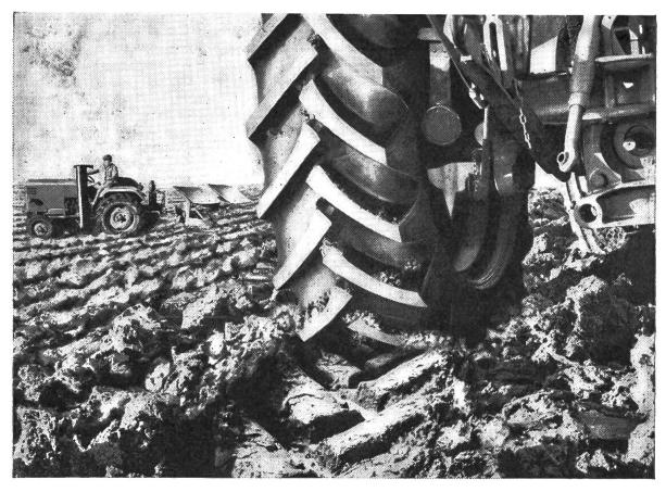
1. Mit den stabilisierten Stollen greift Firestone Rancher selbst auf lockerem Ackerboden oder nassem Wiesland rutschfest; auch am Schräghang. 2. Firestone Rancher ist auch auf Asphaltstrassen dauerhaft haltbar. Er läuft ruhig, und liegt dank der Stollenverbreiterung gegen die Laufflächenmitte fest und gleichmässig auf.
