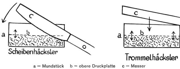
Grenze erreicht. Unsere Abbildung zeigt links das Maul eines Scheibenhäckslers und ein Messer, das gerade beginnt, das zugeführte Futter abzuschneiden. Wenn man das Zuführungsmaul am Schneidwerk vergrössert, also weiter öffnet, um eine höhere Leistung zu erzielen, dann entsteht ein sehr unvorteilhafter Schnittwinkel beim Beginn des Schnittes. Die bekannte Folge davon ist, dass das Häcksel ungleichmässig lang wird und immer wieder Ueberlängen entstehen.
