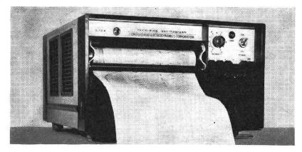
Abb. 4: Aufbau eines Lichtstrahloszillographen.
