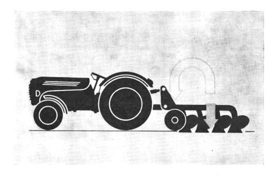
Abb. 4: Schwimmstellung: Für Arbeiten mit geringer Zugkraft, z.B. Stoppelsturz, wird auf Schwimmstellung geschaltet. Man verliert dabei zwar den Vorteil der zusätzlichen Hinterachsbelastung fast zur Gänze, doch ist dies bei diesen Arbeiten kaum erforderlich. Der Vorteil liegt aber ohne Zweifel in dem schöneren Arbeitsbild.
