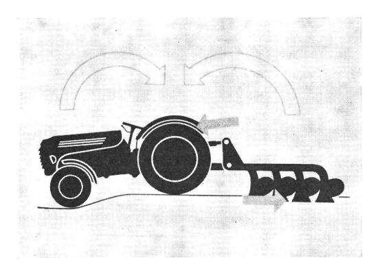
Abb. 3: Fahren die Vorderräder in eine Bodenmulde, so würde der Pflug aus dem Boden gehen. Durch die Verringerung der Zugkraft wird jedoch über den Oberlenker sofort der «Befehl» auf «Senken» erteilt bis die gewünschte Arbeitstiefe wieder erreicht ist. Ist statt der Mulde eine Bodenerhebung, dann wird der umgekehrte «Befehl», nämlich «Heben», gegeben.
