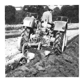
Abb. 6: Kurze Pflüge bereiten der Regelhydraulik keine Schwierigkeiten.
