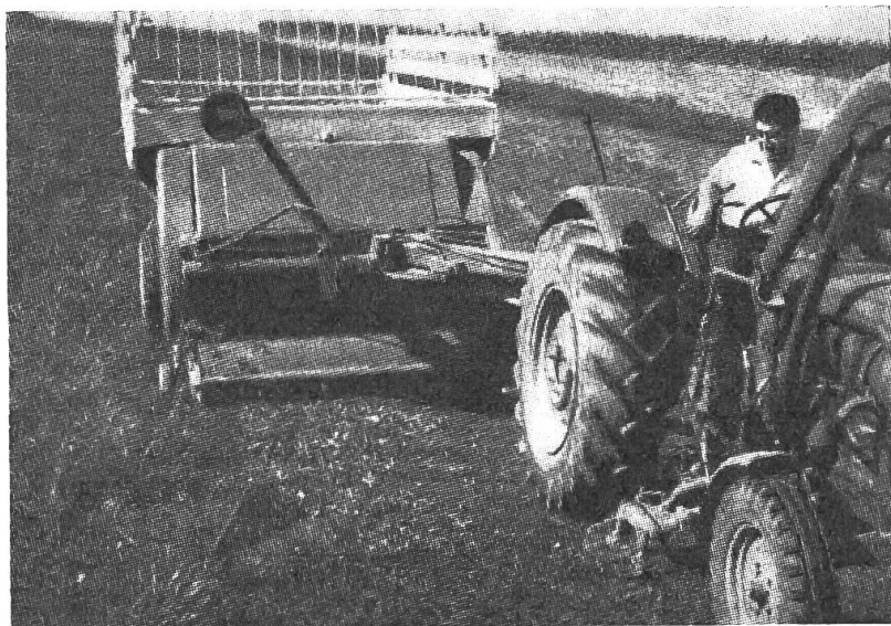
Abb. 20: Mit dem ausschwenkbaren Ladewagen kann die vom Traktor gemähte Mahd im gleichen Arbeitsgang geladen werden. Bei den ausgeschwenkten Tiefgang-Ladewagen (unser Bild) läuft allerdings das rechte Rad bedenklich nahe am noch stehenden Bestand vorbei.
