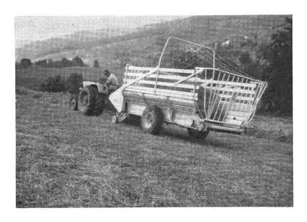
unebenheiten wird das gestossene Pick-up ziemlich strapaziert. Dem kann allerdings entgegengewirkt werden, indem ein Teil des Gewichtes durch Federn abgehoben wird und somit die Tasträder nur schwach belastet sind.
