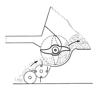
Abb. 6: Arbeitsschema einer einfachen (nicht gesteuerten Fördertrommel).
