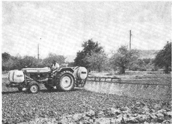
Die neue Grossraumspritze «Rau-Kombi-Kolbran» für 15 m Arbeitsbreite. 1000 Liter Brühe können mitgeführt werden. In der «Rau-Fronthitch» 400 l und am Heck 600 l.
