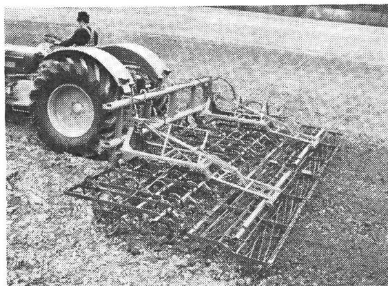
«Rau»-Kombination «Gigant» zur Saatbeetbereitung, mit 6,60 m Arbeitsbreite, für Traktoren ab 120 PS (!). Die beiden 3,30 m breiten Teile werden hydraulisch angehoben.
