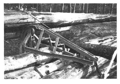
Mittels Kette wird der Stapelbock in der Tiefe am Boden- od. Zwischenlager verankert (siehe Pfeil). Das Seil läuft von der Tiefzugrolle her über die untere Bockrolle, um die hintere Umlenkrolle zur oberen Bockrolle und von da um den aufzuziehenden Stamm.
