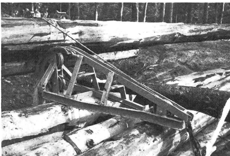
Mittels Kette wird der Stapelbock in der Tiefe am Boden- od. Zwischenlager verankert (siehe Pfeil). Das Seil läuft von der Tiefzugrolle her über die untere Bockrolle, um die hintere Umlenkrolle zur oberen Bockrolle und von da um den aufziehenden Stamm. Das Ende des Seiles ist oben am Bock verankert.
