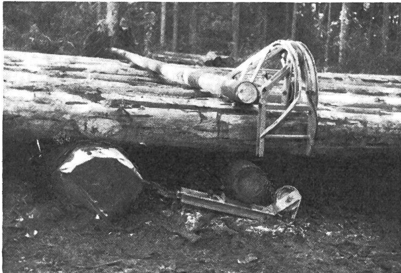
Der Stapelbock lagert auf den ersten drei Stämmen. Am Kopf des Bodenlagers ist die Tiefzugrolle befestigt.
