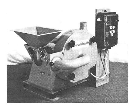
Die von der Industrie lieferbaren Futtermischer haben ein Fassungsvermögen von 300 bis 2000 kg und benötigen zum Antrieb der Mischschnecken Elektromotoren von 3 bis 7,5 PS.
