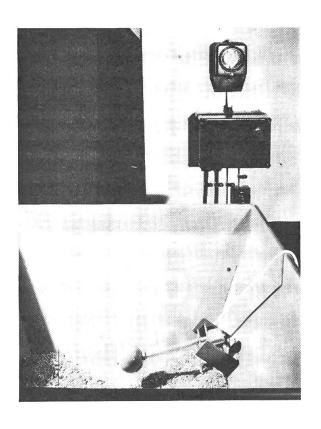
Abb. 4: Leermeldeschalter im Korntrichter der Hammermühle der Siemens-Schrotmühlenautomatik mit Schaltuhr. (Werkbilder Fa. Siemens)
