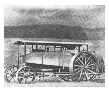
Auch die Elektrizität wurde einst als Antriebskraft verwendet. Das Bild zeigt den Elektro-Seilpflug «Siemens».
