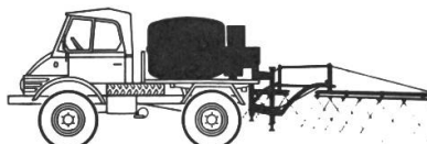
Unimog mit Feldspritze. Arbeitsbreite bis 20 m. 1000-l-Tank auf der Pritsche.
