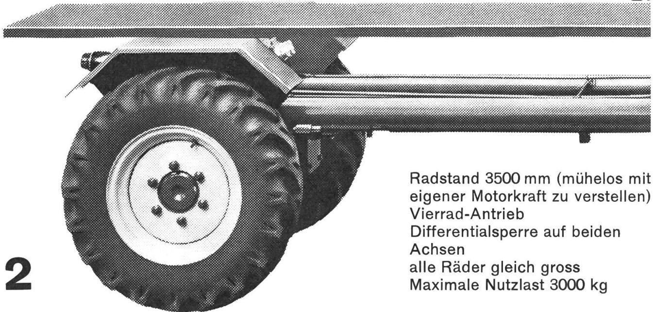
Radstand 3500 mm (mühelos mit eigener Motorkraft zu verstehen)
