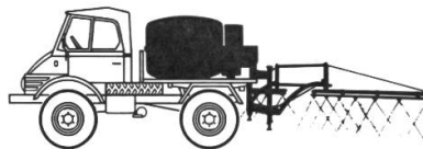
Unimog mit Feldspritze. Arbeitsbreite bis 20 m. 1000-l-Tank auf der Ladepritsche.
