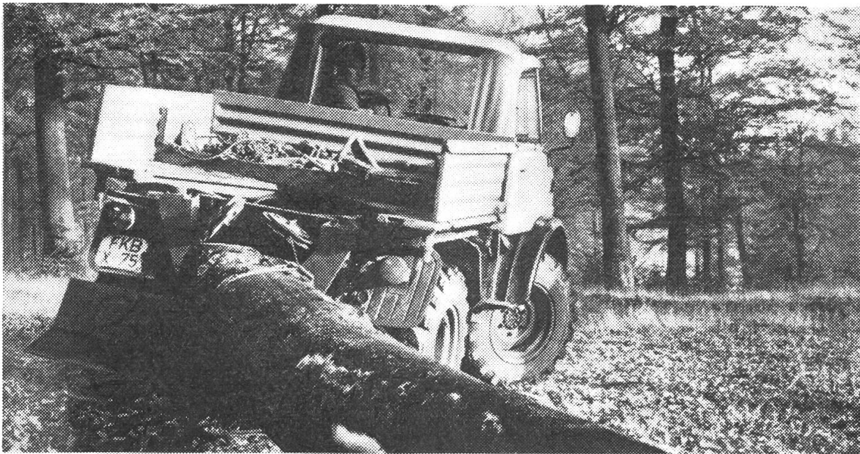
Mit Allradantrieb und Differentialsperre in beiden Achsen schafft er jedes Gelände.
