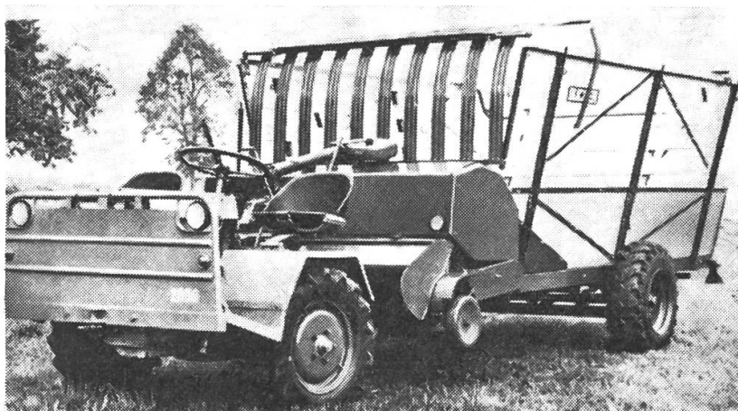
Abb. 2: Das Vordergestell eines Transporters (22 PS) mit angekoppeltem Lade- wagen (man beachte die tiefe Schwerpunktlage).
